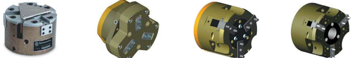
Garra Paralela 3 Jaws RPC Força Fechamento: 13.345N. Cursos: 8 a 35 mm. Garra de Came com Plate. Garra Paralela 3 Jaws DTH Força Fechamento: 44.354N. Cursos: 4 a 70 mm. Garra de Came com Mola. Garra Paralela 3 Jaws REP Força Fechamento: 2.180N. Cursos: 10 a 30 mm. Garra de Came com Mola. Garra Paralela 3 Jaws RPC Força Fechamento: 4.332N. Cursos: 10 a 30 mm. Garra com Furo Passante.
