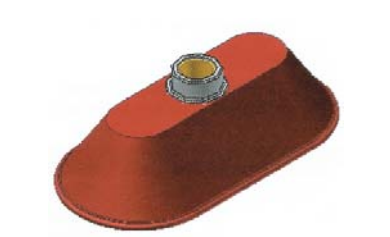
Ventosas Linha Fole Oval Material: Borracha Nitrílica. Diâmetro: 75x150mm. Durezas: 30 e 45 Shore.
