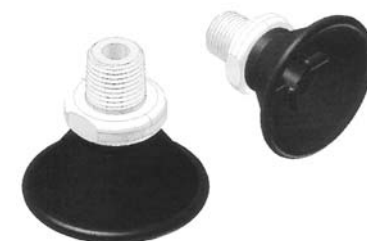
Ventosas Linha Universal Material: Borracha Nitrílica, Silicone, Vinil e Poliuretano. Diâmetros: 4,6 a 100 mm. Durezas: 30 e 45 Shore.
