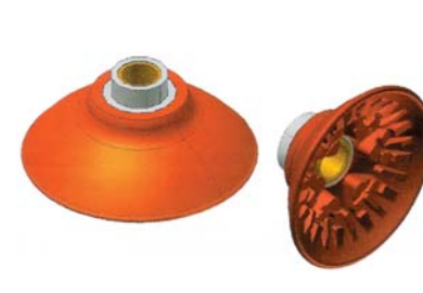
Ventosas Linha Flat Material: Borracha Nitrílica. Diâmetros: 50 a 125 mm. Durezas: 30, 45 e 60 Shore.
