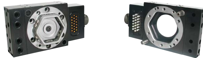
Trocadores de Ferramentas de Multi funções. Alta Precisão, Grande Rigidez para Pequenas, Médias e Altas Cargas de Manipulação. Permite Trabalho com Ar Comprimido, Vacuum, Fluidos Hidráulicos e Refrigerantes. Rede Device NET, Contatos Elétricos Auxiliares e Contatos de Alta Corrente.
