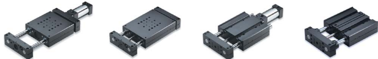
Guia Pneumática DLB-N Carga: 2 a 50 kg. Cursos: 0 a 650 mm. Cilindros ISO 6431/6432. Guia Pneumática DLB-B Carga: 1 a 50 kg. Cursos: 0 a 175 mm. Cilindros Internos. Guia Pneumática DLT-N Carga: 2 a 100 kg. Cursos: 0 a 700 mm. Cilindros ISO 6431/6432. Guia Pneumática DLT-B Carga: 2 a 50 kg. Cursos: 0 a 175 mm. Cilindros Internos.
