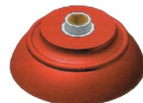
Ventosas Linha Deep Dish Material: Borracha Nitrílica. Diâmetros: 50 a 100 mm. Durezas: 30 e 45 Shore.
