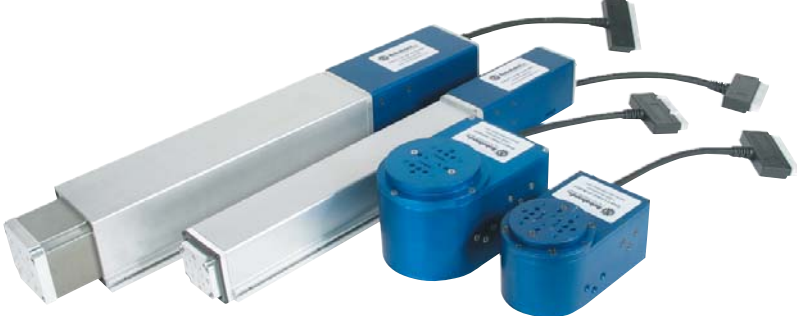
E-CYLINDER Eixos com Fuso de Esfera acionados por Motor de Passo. Carga Máxima: 50 kg. Curso: 50 a 250 mm. Velocidade Máxima: 600 mm/s. Precisão/Repetibilidade: 0,04 mm.
