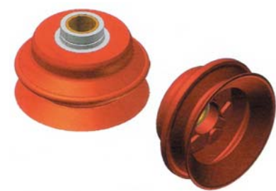
Ventosas Linha Fole Simple Material: Borracha Nitrílica. Diâmetros: 40 a 125 mm. Durezas: 45 e 60 Shore.
