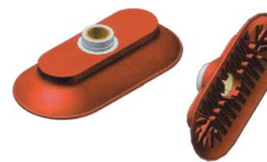
Ventosas Linha Flat Oval Material: Borracha Nitrílica. Diâmetros: 25x75 mm a 75x150mm. Durezas: 30 e 45 Shore.
